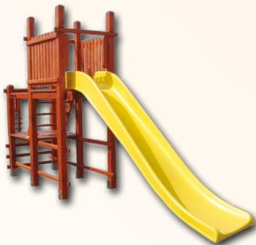
Tobogan s duplim podestom izrađen od kvalitetno obrađenog drveta zaštićenog u tri sloja Sadolin® lakom. Obrada drva: stolarski, blanjanjem te završnom obradom, finim brušenjem. Temeljni nosači su izrađeni od čeličnog lima, zaštićeni su cinčanjem te osiguravaju stabilnost igrala i sigurnost djece. Korito tobogana izrađeno je od poliesterskog laminata dužine 3200 mm, a pričvršćeno je vijčanim spojem na drveni podest sprave.
