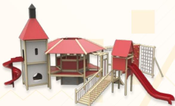
Dvorac je izrađen od kvalitetnih laminiranih oblica Ø130 mm, impregnirano lakom Sadolin® u tri sloja. Konstrukcija je od drvenih greda i daski debljine 50 mm i 24 mm. Svi spojevi učvršćeni pocinčanim torban i iver vijcima.
