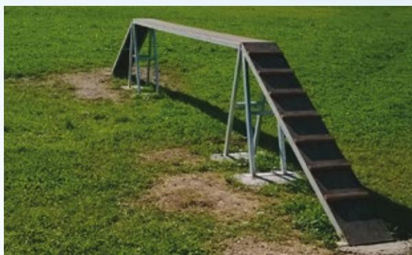
Izrađen od čeličnih kvadratnih cijevi 40x20x2 mm. Obloga mosta vodootporna šperploča-blažujka debljine 22 mm te je dodatno prekrivena protukliznom gumom. Na blažujki letve na svakih 300 mm horizontalno.
