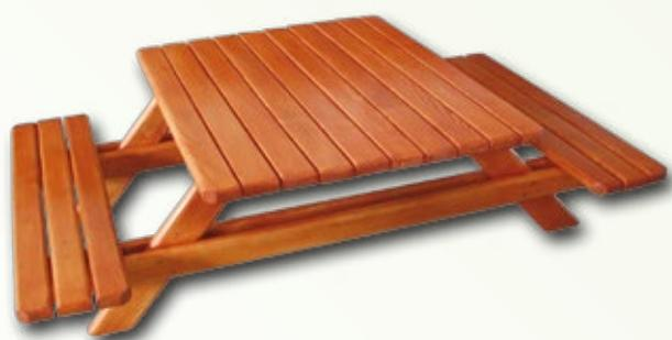
Stol s klupama izrađen je od kvalitetnog drveta zaštićenog u tri sloja Sadolin® lakom. Obrada drva: stolarski, blanjanjem te završnom obradom, finim brušenjem. Drvo zaobljeno na rubovima i brušeno. Svi metalni dijelovi pocinčani. Namjena je za igru djece, u parkovima, dječjim vrtićima, školama.
