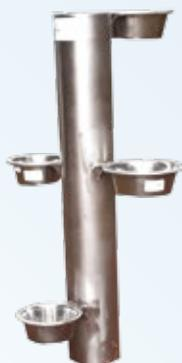
Pojilica se sastoji od nosećeg stupa pričvršćenog na temelj ukopan u tlu. Nosivi stup sastoji se od inox cijevi promjera 150 mm na koju su obodno pričvršćeni inox prstenovi (4 prstena) na različitim visinama (3 visine). Prstenovi se javljaju u dva promjera (promjer unutar kojih se odlažu pomične metalne zdjelice za vodu).
