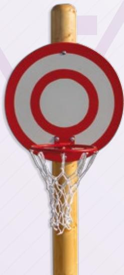
Izrađen od kvalitetnih laminiranih oblica Ø130 mm, impregnirano Sadolin® lakom u tri sloja. Tabla od vodootporne šperploče – blažujke debljine 22 mm. Obruč od čelične cijevi zaštićen temeljem i lakom. Konstrukcija pomoću metalnih pocinčanih ankera i vijaka stabilizirana u podlozi. Svi spojevi učvršćeni pocinčanim torban i iver vijcima.
