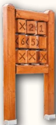
Ploča je izrađena od kvalitetno obrađenog drveta zaštićenog u tri sloja Sadolin® laka. Obrada drva: stolarski, blanjanjem te završnom obradom, finim brušenjem. Svi oštri bridovi su otklonjeni zbog sigurnosti izvedbom radijusa R20. Drvena konstrukcija međusobno je spojena urezivanjem preklopa, ljepljenjem te osigurana pocinčanim iver vijcima. Unutar ploče kockice dim. 160x120x120 mm koje se okreću na inox šipki ø12 mm. Na kockama oznake X i O te brojevi 1-9.
