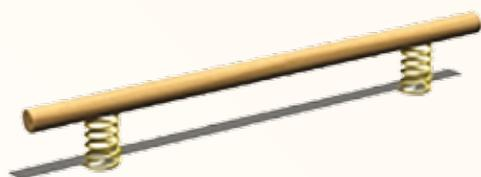
Sprava izrađena od lameliranog drveta zaštićenog u 3 sloja Sadolin® lakom. Greda je dužine 3000 mm, visine 400 mm, širine 200 mm,  $\varnothing$ 140 mm. Greda postavljena na dvije opruge. Temelji koji se učvršćuju u zemlju su cinčani.
