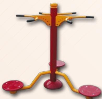
Sprava je izrađena iz okruglih čeličnih cijevi, ojačana toplovaljanim limom debljine 8 mm. Klizni ležajevi su izrađeni iz elektro bronce sa ugrađenim mazalicama. Okretni podovi izrađeni od HDPE ploče debljine 19 mm. Čelična konstrukcija zaštićena temeljnom bojom i završnim lakom. Sprava se preko sidrene stope učvršćuje na betonsku podlogu.
