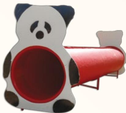
Skrivalica je izvedena u obliku tunela izrađenog od poliesterskog laminata u boji vanjskog promjera Ø800 mm. Na ulazu/izlazu tunela nalazi se HDPE ploča debljine 19mm koja je vijcima učvršćena za priрубnicu tunela. Izvedena je u obliku životinjskog lika – pande. Cijeli sklop je postavljen na tri čelična nosača kojima se skrivalica učvršćuje na podlogu vijcima ili u podlogu betoniranjem. Metalni dio zaštićen je temeljnim premazom te završnim lakom.
