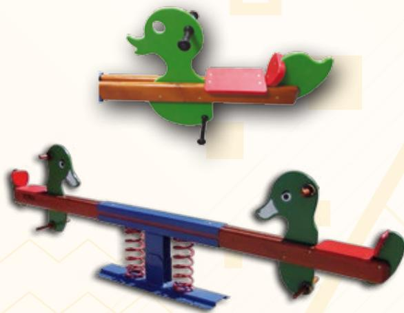
Klatilica je izrađena od kvalitetnog drva impregniranog tri puta Sadolin® lakom. Obrada drva: stolarski, blanjanjem te završnom obradom, finim brušenjem. Figura lika, sjedalica i naslon izrađeni od HDPE ploče debljine 19 mm. Metalni ovjes izrađen od dekapiranog lima zaštićenog temeljnim premazom i završnim lakom. Na njega su rudarskim stegama pričvršćene čelične opruge. Mogućnost izrade likova u obliku dupina, patke ili konjića.
