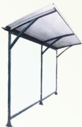
Nosiva konstrukcija izrađena od pocinčanih profila 60x40x3 mm sa držačima za staklo, zaštićena lakom u sivoj boji RAL 7016 te se učvršćuje na lokaciju sidrenim vijcima, na pripremljenu betonsku podlogu. Ostakljenje stražnjih strana nadstrešnice lamistal staklom debljine 10 mm. Nadstrešnica ne sadrži bočne stranice. Stražnji oluk za odvod oborina. Koš za smeće 20 litara sive boje RAL 7016.
