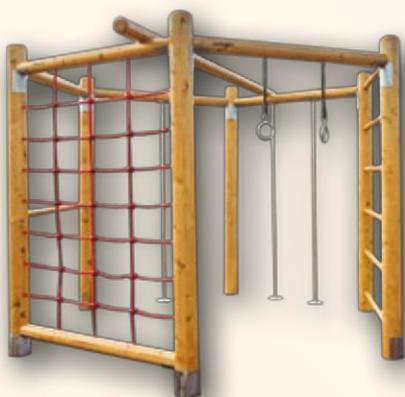
Penjalica izrađena od kvalitetnih laminiranih oblica Ø130 mm, zaštićenih u tri sloja Sadolin® lakom. Mreža za penjanje od čelične žice obložene poliesterom. Dvije poprečne šipke izrađene od pocinčanog čelika. Šipke za penjanje izrađene od pocinčanih čeličnih cijevi. Uže za penjanje od polipropilena. Konstrukcija pomoću metalnih pocinčanih anкера i vijaka stabilizirana u podlozi. Svi spojevi učvršćeni pocinčanim torban i iver vijcima.
