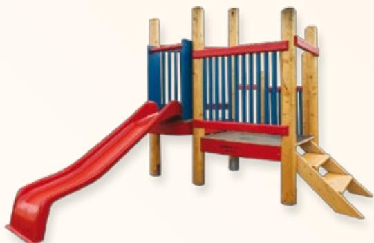
Sprava tip Jaslica izrađena je od kvalitetnih laminiranih oblica Ø130 mm, stolarski obrađenih, impregviranih i zaštićenih u tri sloja Sadolin® laka. Obrada drva: stolarski, blanjanjem te završnom obradom, finim brušenjem. Dio stranica i podnica izrađeni od HDPE ploča debljine 19 mm. Dio ograde izrađen je od stolarske građe zaštićene u tri sloja Sadolin® lakom. Korito tobogana dužine 1400 mm izrađeno od poliesterskog laminata.
