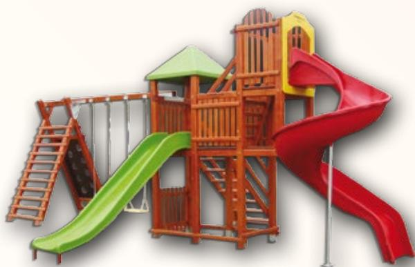
Kombinirana sprava s dva tobogana izrađena je od kvalitetno obrađenog drveta zaštićenog u tri sloja Sadolin® laka. Obrada drva: stolarski, blanjanjem te završnom obradom, finim brušenjem. Sprava se sastoji od obostrane penjalice, ljuljačke sa dvije sjedalice ovješene inox lancima na pocinčani nosač, tornja sa krovicom i ravnim toboganom, stepenica za penjanje na podest višeg podesta sa zavojitim toboganom. Svi oštri rubovi su otklonjeni zbog sigurnosti izvedbom radijusa R20.
