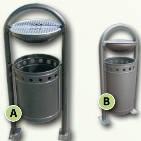
Samostojeći koš za smeće izrađen je od čeličnih cijevi 6/4". Košarica je izrađena od čeličnog lima debljine 1,5 mm, djelovi su spojeni tehnikom varenja u zaštićenoj atmosferi CO<sup>2</sup>, te koš zadovoljava ekološke uvjete proizvodnje. Svi djelovi su zaštićeni temeljnim premazom i lakom. Iznad košarice smještena je pepeljara koja ima poklopac od profiliranog prokrom lima koja se otvara pregibom te omogućuje pražnjenje pepeljare. Koš se može direktno učvrstiti na betonsku površinu.
