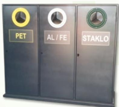
Tri spremnika sa otvorima prilagođenim sekundarnim sirovinama: za PET, za AL/FE i za STAKLO. Izrađen od čeličnog lima i čeličnih cijevi. Zaštićeno temeljnom bojom i završnim lakom. Naljepnice sa natpisom. Unutar spremnika za PET i AL/FE nosač za vreću, u spremniku za STAKLO plastični uložak. Svaki spremnik ima zasebna vrata.
