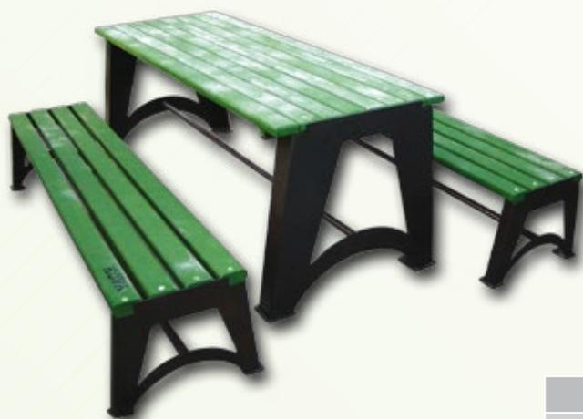
Klupa i stol izrađeni su od čeličnog lima i okruglih cijevi, klupa od drvenih letvica 90x40x1600 mm, stol od drvenih letvica 90x40x2000 mm. Metalni dijelovi su zaštićeni temeljnim premazom i lakom. Drveni dijelovi izrađeni od kvalitetnog drveta zaštićenog u tri sloja Sadolin® lakom. Obrada drva: stolarski, blanjanjem te završnom obradom, finim brušenjem.
