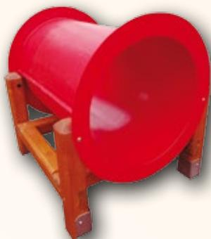
Tunel za provlačenje sastoji se od konstrukcije nosivih drvenih greda dimenzija 120x120 mm. Cijev je napravljena od poliesterskog laminata. Dužina cijevi je 1150 mm, a širina 800 mm. Svi drveni dijelovi izrađeni od visokokvalitetnog obrađenog drveta koji su impregnirani i zaštićeni u 3 sloja Sadolin® lakom.
