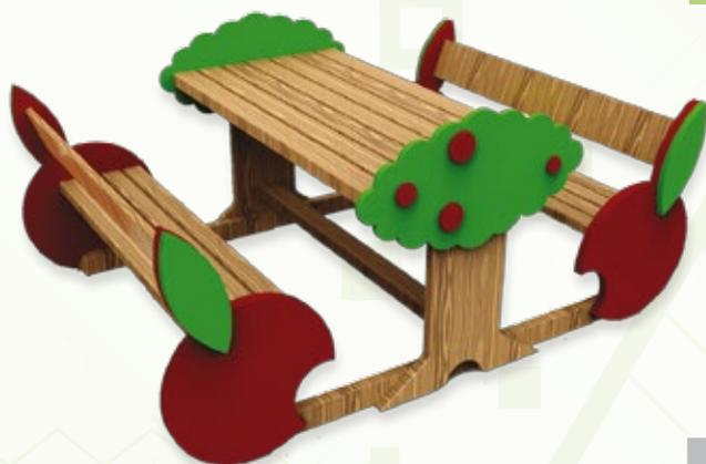
Izrađen od kvalitetnog drveta, stolarski obrađenog, impregniranog i zaštićeno Sadolin® lakom tri puta. Obrada drva: stolarski, blanjanjem te završnom obradom, finim brušenjem. Bočne stranice stola i klupa izrađene su od HDPE ploče debljine 19 mm izvedene u obliku drveta jabuke. Drvo je zaobljeno na rubovima i brušeno. Svi metalni dijelovi su pocinčani.
