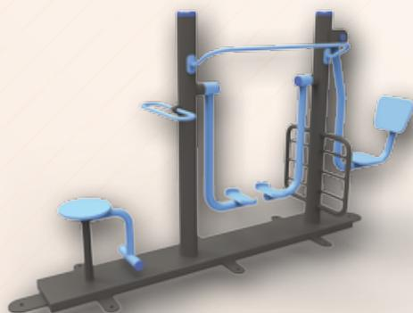
Sprava je izrađena od čeličnih cijevi, profila i limova spojenih zavarivanjem i vijčanom vezom u funkcionalnu cjelinu, temeljena sidrenim vijcima na čvrstu podlogu. Proizvod zaštićen temeljnom bojom i završnim lakom. Sjedalice izrađene od HDPE ploča debljine 19 mm.
