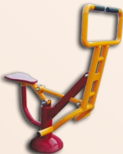
Sprava je izrađena iz okruglih čeličnih cijevi, ojačana toplovaljanim limom debljine 8 mm. Klizni ležajevi su izrađeni iz elektro bronce sa ugrađenim mazalicama. Sjedalica od HDPE ploče debljine 19 mm. Čelična konstrukcija zaštićena temeljnom bojom i završnim lakom. Sprava se preko sidrene stope učvršćuje na betonsku podlogu.
