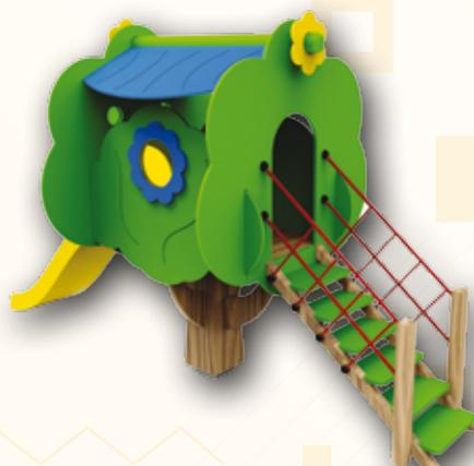
Podkonstrukcija izrađena od čeličnih cijevi  $\varnothing 102\text{ mm}$  i  $\varnothing 48\text{ mm}$ . Krošnja drveta i krov izrađeni od HDPE ploče debljine 19 mm. Podnica sprave izrađena od HDPE ploče debljine 19mm. Korito tobogana izrađeno od poliesterskog laminata. Konstrukcija pomoću metalnih pocinčanih ankera i vijaka stabilizirana u podlozi. Svi spojevi učvršćeni pocinčanim torban i iver vijcima. Drvene stepenice vode na podest od HDPE ploče.
