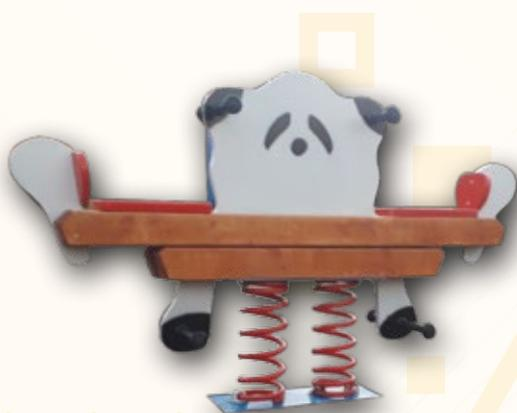
Njihalica na dvije opruge s dvije sjedalice izrađena je od kvalitetnog drva impregniranog tri puta Sadolin® lakom. Obrada drva: stolarski, blanjanjem te završnom obradom, finim brušenjem. Figura lika, sjedalice i naslon izrađeni od HDPE ploče debljine 19 mm. Metalni ovjes izrađen je od dekapiranog lima zaštićenog temeljnim premazom i završnim lakom. Mogućnost izrade lika pande ili žabice.
