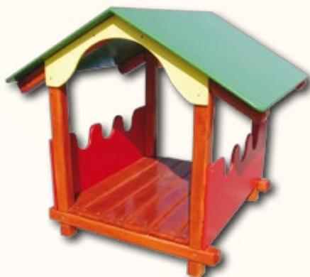
Kućica za djecu izrađena je od kvalitetno obrađenog drveta zaštićenog u tri sloja Sadolin® laka. Obrada drveta: stolarski, blanjanjem te završnom obradom, finim brušenjem. Pod kućice izrađen je od fosni. Stijene, krov i klupe izrađene od HDPE ploče debljine 19 mm. Svi spojevi učvršćeni su pocinčanim torban i iver vijcima.
