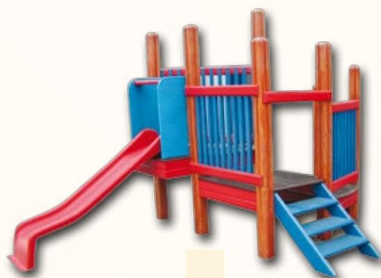
Sprava tip Vrtić izrađena je od kvalitetno obrađenog drveta zaštićenog u tri sloja Sadolin® laka. Obrada drva: stolarski, blanjanjem te završnom obradom, finim brušenjem. Dio stranica i podnica izrađeni od HDPE ploča debljine 19 mm. Dio ograde izrađen je od stolarske građe zaštićene u tri sloja Sadolin® lakom. Korito tobogana dužine 1400 mm izrađeno od poliesterskog laminata.
