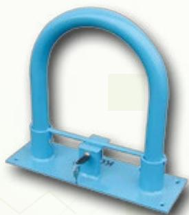
Preklopni branik tip KOVA 8 služi za zaštitu parkirnog mjesta od nekontroliranog parkiranja. Dimenzije preklopnog branika: 400x406x100 mm. Temeljna ploča dimenzija 400x100 mm sa četiri turbo vijka učvršćuje se u betonsku ili asfaltnu podlogu. Tijelo branika izrađeno je od cijevi Ø40 i visina branika iznosi 400 mm. Mehanizam za dizanje i spuštanje branika sa cilindar bravom i dva komada ključa. Sve zaštićeno temeljnom bojom i lakom.
