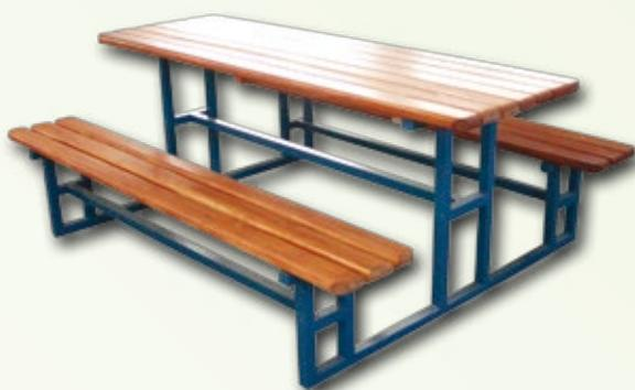
Komplet stol sa dvije klupe kao jedna cjelina. Konstrukcija stola i klupa izrađena od metalnih kvadratnih cijevi, a sjedala klupa i ploča stola izrađena od kvalitetnog drveta zaštićenog u tri sloja Sadolin® lakom. Obrada drva: stolarski, blanjanjem te završnom obradom, finim brušenjem.
