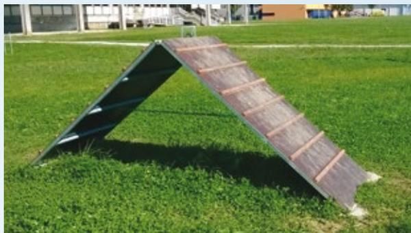
Podkonstrukcija je izrađena od čeličnih kvadratnih cijevi 40x20x2 mm. Obloga penjalice od vodootporne šperploče –blažujke debljine 22 mm te je dodatno prekrivena protukliznom gumom. Na blažujki se nalaze letve na svakih 300mm horizontalno. Ugrađeni lanac omogućava različiti kut penjalice. Izrada konstrukcije "cijev u cijev" radi sigurnosti psa pri prelasku na vrhu.
