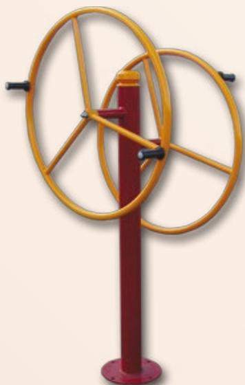
Sprava je izrađena iz okruglih čeličnih cijevi, ojačana toplovaljanim limom debljine 8 mm. Klizni ležajevi su izrađeni iz elektro bronce sa ugrađenim mazalicama. Čelična konstrukcija zaštićena temeljnom bojom i završnim lakom. Sprava se preko sidrene stope učvršćuje na betonsku podlogu.
