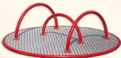
Vrtuljak je izrađen od čeličnih cijevi zaštićenih temeljnim premazom i završnim lakom. Ležajevi ugrađeni na osovini osiguravaju laganu rotaciju vrtuljka. Pod izrađen iz aluminijskog suza lima 3/4".
