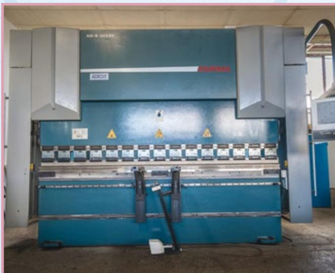
Savijanje lima hidrauličnom prešom -
