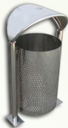
Koš izrađen od inox cijevi Ø50 mm i inox lima 1,00 mm. Dimenzija koša 510x390x1000 mm. Koš je izrađen od dva dijela:
