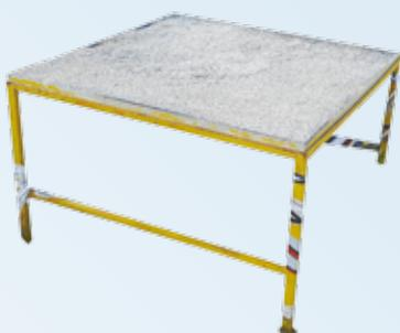
Metalni stol izrađen od 4 kvadratne cijevi 30x30x2 mm koje su međusobno povezane "L" profilima. Na gornjem dijelu se nalazi vodootporna šperploča - blažujka debljine 22 mm te protuklizna guma. Konstrukcija zaštićena temeljnom bojom i lakom.
