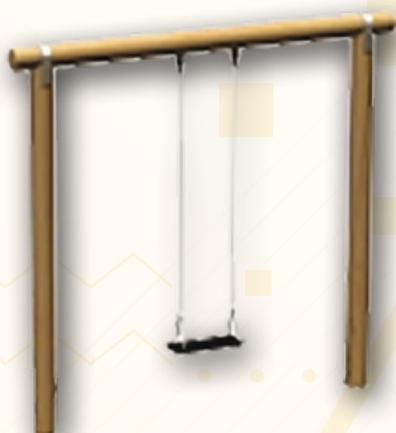
Izrađena od kvalitetnih laminiranih oblica Ø130 mm, impregniranih lakom. Drveni dijelovi na rubovima zaobljeni i brušeni. Konstrukcija pomoću metalnih pocinčanih anкера i vijaka stabilizirana u podlozi. Sjedalica izrađena od poliesterskog laminata, ovješana inox lancima na nosač.
