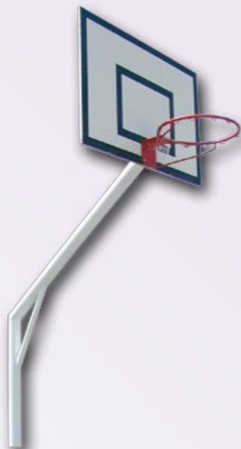
Nosač košarkaškog koša izrađen je od čeličnih profila, zaštićen temeljnim premazom i lakom bijele boje. Ploča je izrađena od vodootporne šperploče – blažujke debljine 22 mm. Na ploču je pričvršćen metalni obruč sa mrežicom. Koš se montira ubetoniravanjem u svježi beton.
