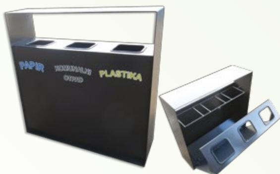
Ormar izrađen od čeličnog lima debljine 3 mm. Na vrhu ormara se nalaze tri otvora. Na prednjoj strani su otklopna vrata sa ključem. Unutar ormara su tri obruča za vreće za svaku vrstu sekundarnih sirovina. Sve zaštićeno temeljnom bojom i završnim lakom. Naljepnice prema vrsti sekundarne sirovine.
