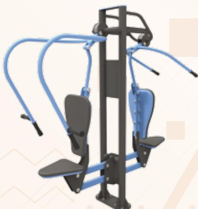
Sprava je izrađena od čeličnih cijevi, profila i limova spojenih zavarivanjem i vijčanom vezom u funkcionalnu cjelinu, temeljena sidrenim vijcima na čvrstu podlogu. Proizvod je zaštićen temeljnim premazom i bojom. Sjedište izrađeno od HDPE ploča debljine 19 mm.
