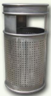
Izrađen od perforiranog inox lima debljine 1 mm i inox cijevi Ø18 mm. Na gornjoj strani se nalazi poklopac na okretni mehanizam koji u zatvorenom položaju služi kao pepeljara. Koncipiran je za ubacivanje otpada sa strane u vrećicu koja se postavlja na pokretni uložak. Koš se može direktno učvrstiti na betonsku površinu.
