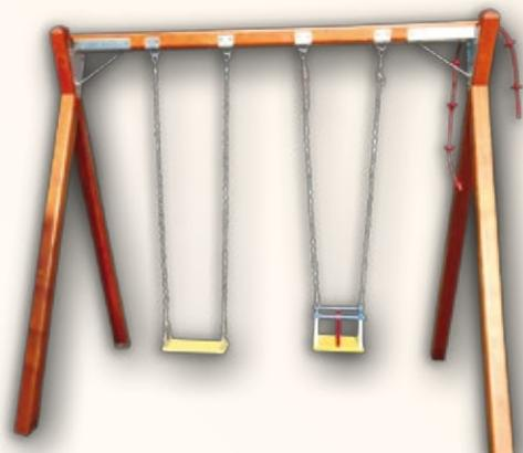
Ljulačka je izrađena od kvalitetnog drva stolarski obrađenog, impregniranog i zaštićenog u tri sloja Sadolin® lakom. Obrada drva: stolarski, blanjanjem te završnom obradom, finim brušenjem. Svi oštri bridovi su otklonjeni zbog sigurnosti izvedbom radijusa R20. Jedna sjedalica izrađena od poliesterskog laminata, ovješene inox lancima na pocinčani nosač. Druga sigurnosna sjedalica, tzv. baby sjedalica izrađena od polietilena.
