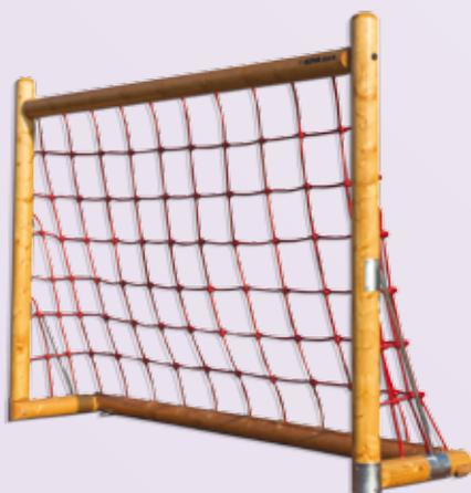
Izrađen od kvalitetnih laminiranih oblica Ø130 mm, impregnirano Sadolin® lakom u tri sloja. Mreža za gol od čelične žice obložene poliesterom. Konstrukcija pomoću metalnih pocinčanih ankera i vijaka stabilizirana u podlozi. Svi spojevi učvršćeni pocinčanim torban vijcima.
