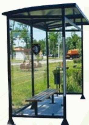
Izrađena od pocinčanih kvadratnih čeličnih profila. Bočne strane i stražnja strana od lamistal stakla debljine 10 mm. Krov izrađen od pocinčanih kvadratnih čeličnih profila 60x40x3 mm s limenim žlijebom, na prednjoj i zadnjoj strani prekriven polikarbonatnom pločom debljine 10 mm u sivoj boji. Konstrukcija završno zaštićena lakom u sivoj boji RAL 7016. Klupa s naslonom izrađena od kvalitetno obrađenog drveta zaštićenog Sadolin® lakom. Koš za smeće 20 litara sive boje RAL 7016.
